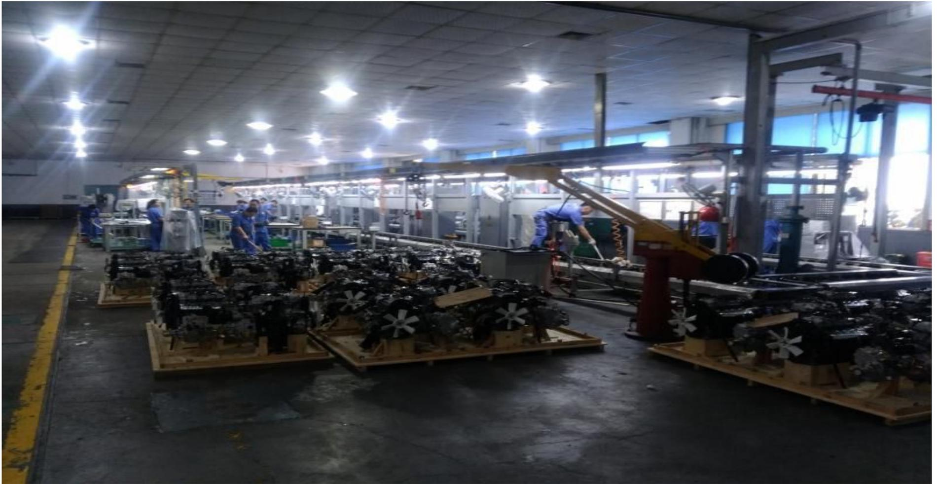
图 2.3 年产5万台单缸柴油机技改生产线
